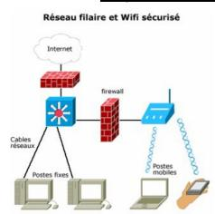
On peut aussi installez un **firewall** comme si le point d'accès était une connexion internet. Ce firewall peut être le serveur **IPsec** (VPN) des clients sans fils.
