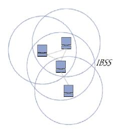
En mode **ad hoc**, les machines sans fil clientes se connectent les unes aux autres afin de constituer un **réseau point à point** (*peer to peer* en anglais), c'est-à-dire un réseau dans lequel chaque machine joue en même temps de rôle de client et le rôle de point d'accès.
